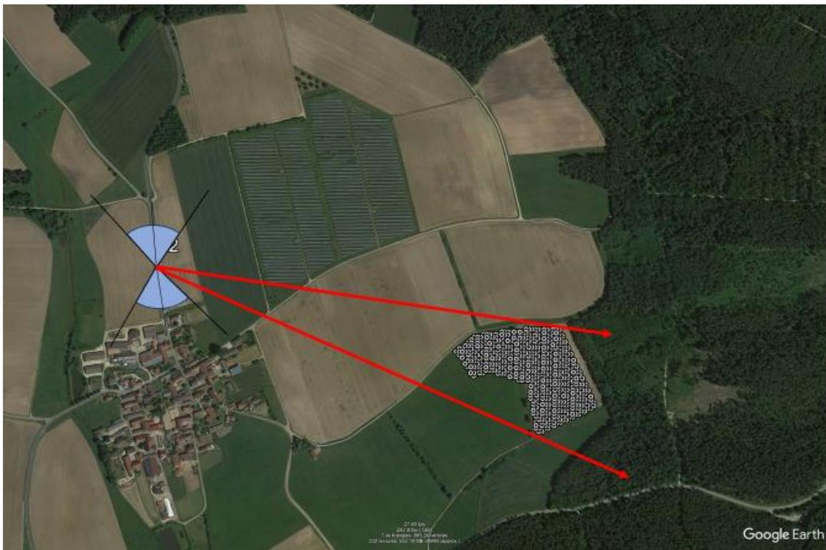
Abbildung 19: Vergleich Sichtfeld Zugführer für Punkt B2 mit Grenzvektoren in Richtung Module
